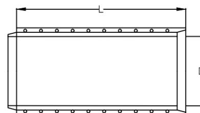
CORTE LONGITUDINAL PARA ENCAIXE TIPO PONTA E BOLSA
