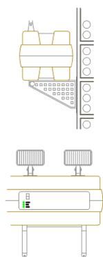
ILUMINAÇÃO DE EMERGÊNCIA (1) BLOCO AUTÔNOMO (2x55W)
