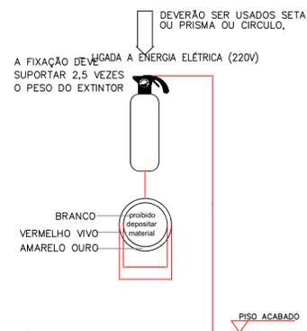
DETALHE INSTALAÇÃO EXTINTORES SEM ESCALA
