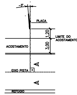
DETALHE DE POSICIONAMENTO (MA)
