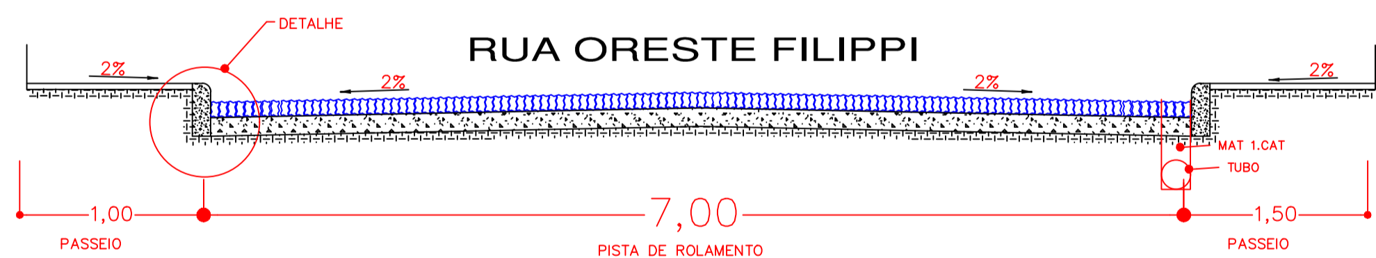
SECAO TRANSVERSAL DO PAVIMENTO sem escala
